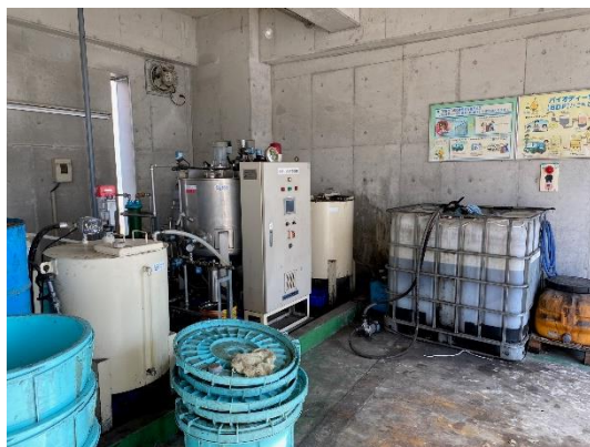
図 20 大木町資源循環センターのバイオディーゼル燃料精製装置
