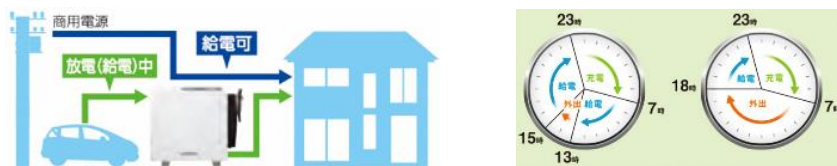
図 28 EVから公共施設に電気を供給する場合の給電時間帯例
