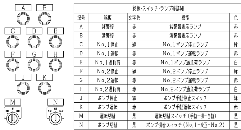
ポンプ操作部スイッチ、ランプ類詳細
