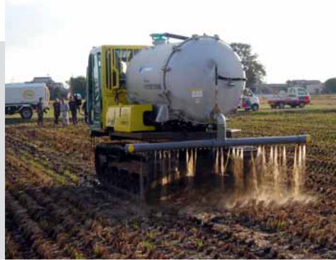
循環センター「くるるん」関連設備(液肥散布車)
