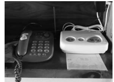
緊急通報システム専用器とペンダント
