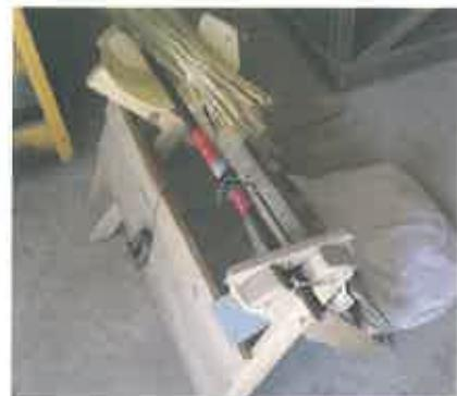
作成者が藁芭を作成するための機械も作り、とても精巧に糸を編むことができる
